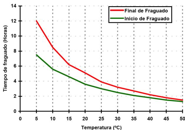
Afortunadamente, el fraguado y el endurecimiento del hormigón pueden acelerarse químicamente mediante la utilización de unos aditivos especiales químicos acelerantes, facilitando de esta manera las operaciones de acabado y recirculación de los encofrados en la estación invernal.
